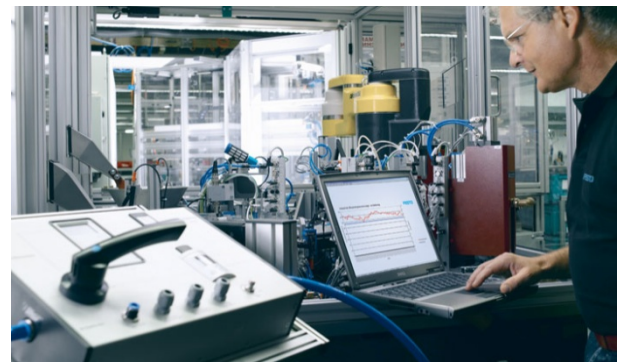
Abbildung 11: Messung des Druckluftverbrauchs
