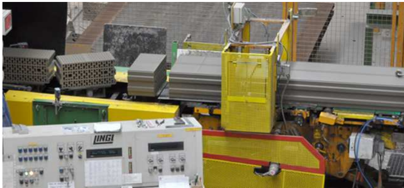
Abbildung 10: Ziegelherstellung – nach der Extrusion wird der Strang getrennt 33
