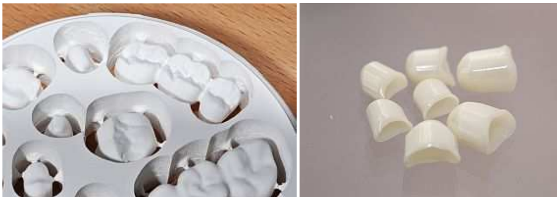
Abbildung 18: Dentalkeramik Fertigung durch Fräsen 51
