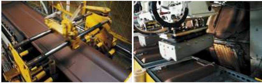
Abbildung 12: Zweistufige Formgebung von Dachziegeln durch Extrusion (links) und Pressen (rechts) 37
