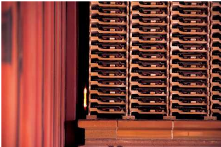
Abbildung 13: Dachziegel in H-Kassetten auf dem Weg zum Ofen 38
