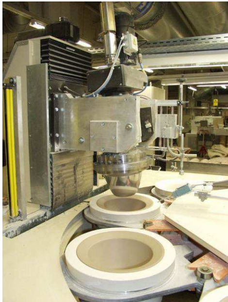
Abbildung 8: Rollertechnik in der Blumentopf-Fertigung 29
