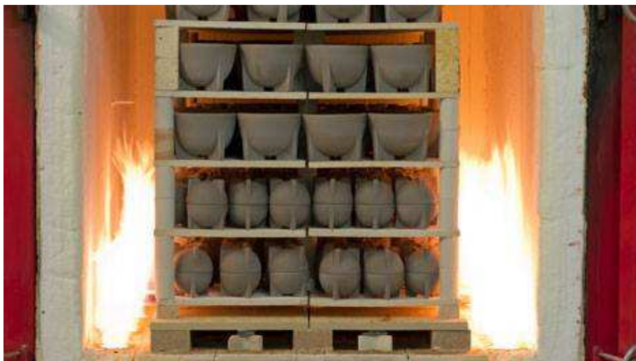
Abbildung 5: Blick in einen Ofen mit keramischen Komponenten auf Brennhilfsmitteln 26
