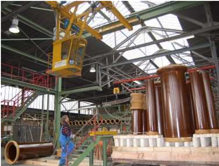
Abbildung 14: Steinzeugrohre, gebrannt und glasiert auf einem Herdwagen 39
